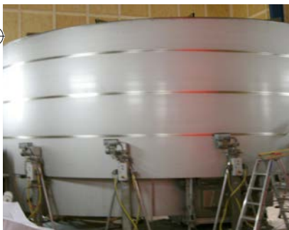
Abb. 8: Vollautomatisches Schweißen des Tanks (Außenansicht)
