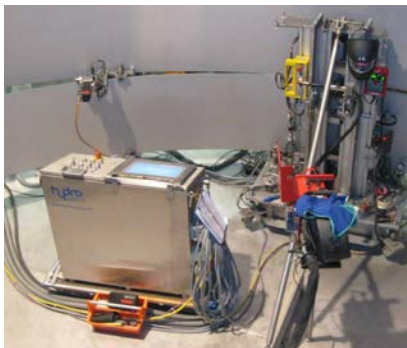
Abb. 7: Vollautomatisches Schweißen des Tanks (Schweißautomat, Ansicht von innen)
